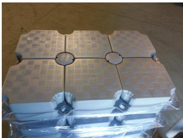
2. **Estrutura flutuante** consistindo em 134 submontagens, cada submontagem constituída por seis cubos de polietileno de alta densidade (HDPE), cujo interior é guarnecido com poliestireno expandido. As submontagens devem ser interligadas para formar estruturas flutuantes predefinidas maiores, como, por exemplo, docas flutuantes, passarelas flutuantes, plataformas de trabalho flutuantes, marinas, etc.
