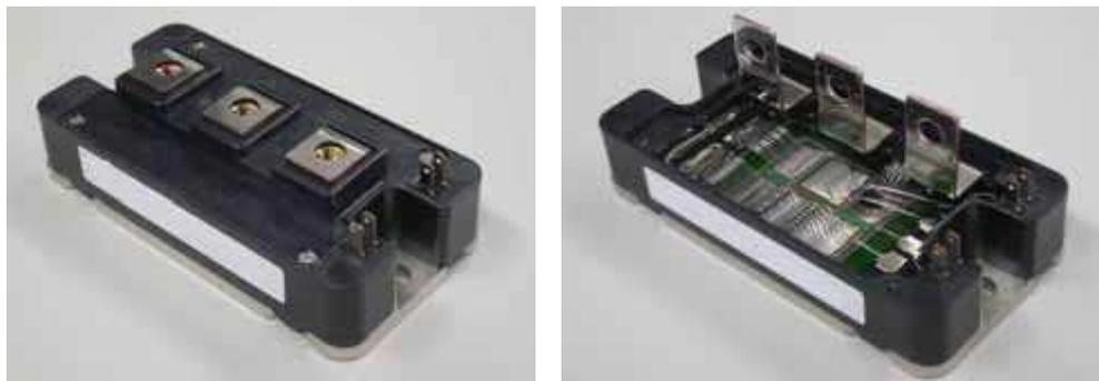
2. **Módulo de transistores bipolares de porta isolada (IGBT)**, (dimensões: 62 mm x 106 mm x 36 mm) que contém 1 transistor bipolar de porta isolada, 1 diodo numa conexão antiparalela ao transistor para evitar danos que possam causar uma corrente inversa quando o transistor está desligado e vários eletrodos. Estes elementos estão conectados uns aos outros por fios de alumínio e encapsulados numa caixa de plástico.
