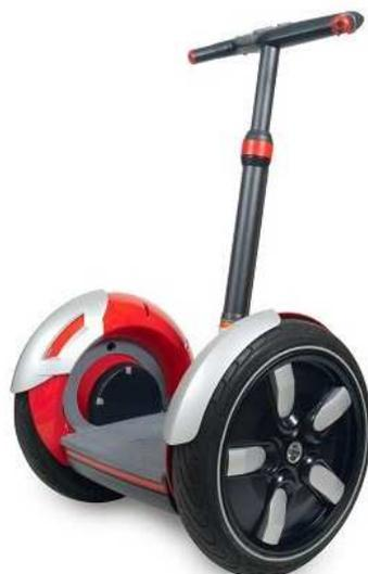
2. **Dispositivo de duas rodas, autoequilibrado, de propulsão elétrica**, concebido para o transporte de apenas uma pessoa em vias de baixa velocidade, como calçadas, caminhos e ciclovias. A velocidade máxima do dispositivo é de 10 km/h e a distância máxima percorrida entre duas recargas da bateria é de 15 a 20 km.
